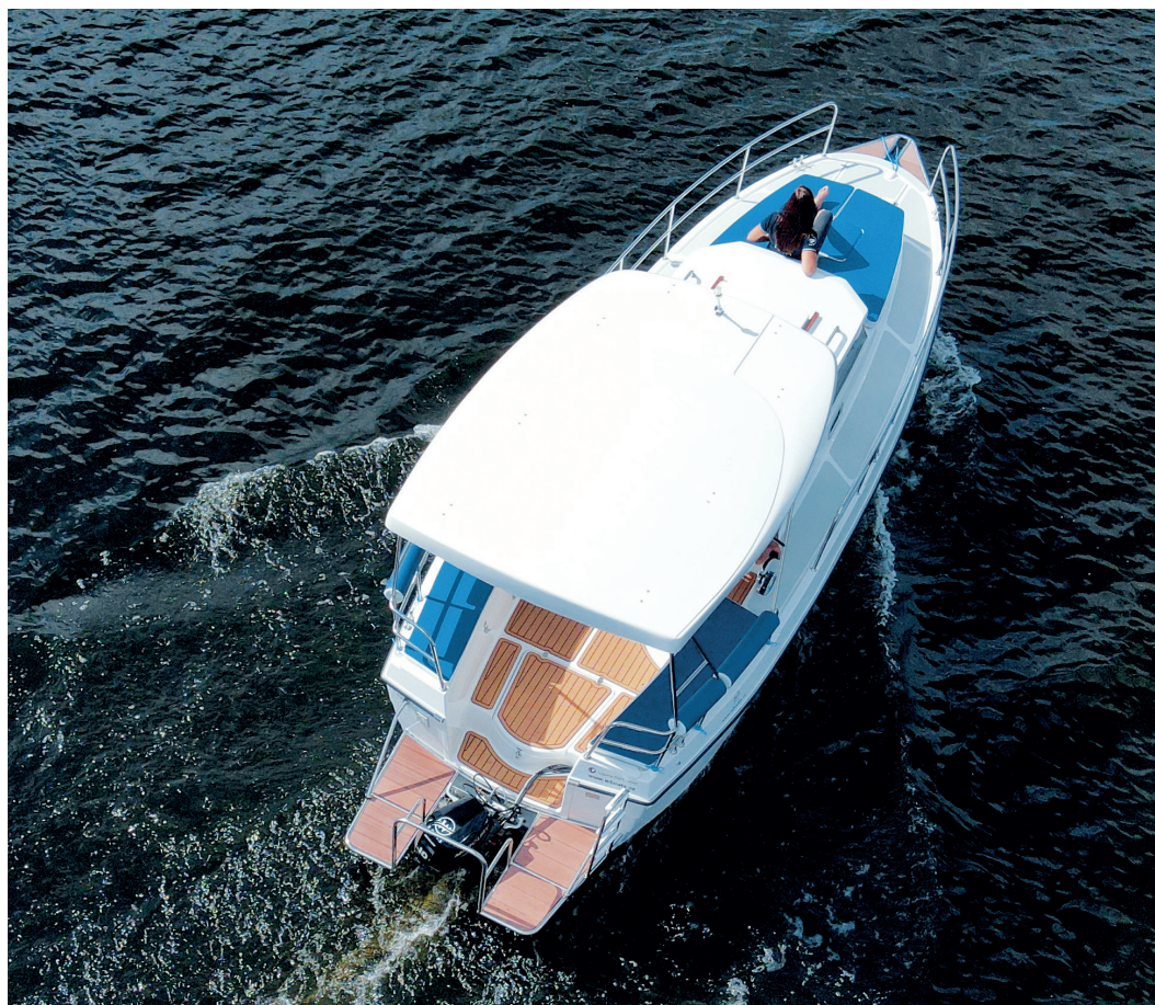
Zadní platforma slouží jako nástupní nebo koupací plošina a zároveň chrání přívěsný motor.
