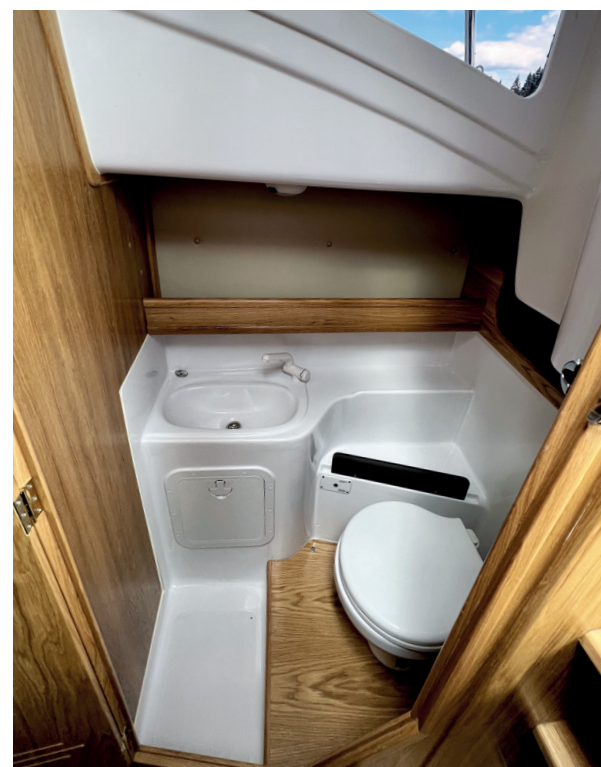
Na testované lodi byla toaleta s elektrickým splachováním a odpadní nádrží.
